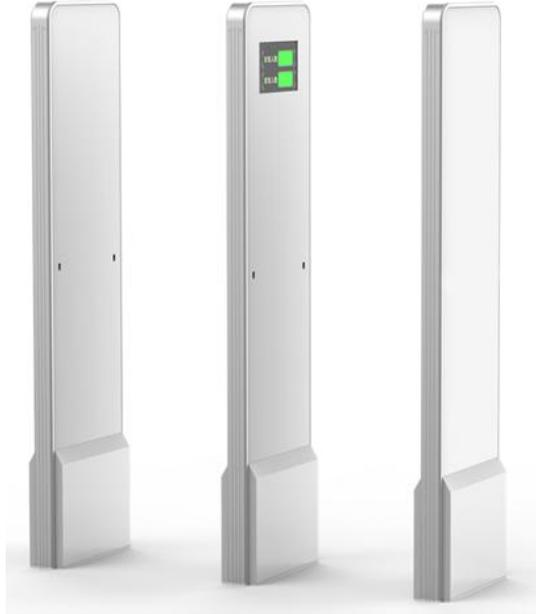
**产品简介：**XC-BM213 门禁设备是一款高性能的电子标签通道机，系统采用超高频(UHF)RFID 技术，配备高性能主副通道天线，可快速检测经过通道的多标签，并对非法标签进行声光报警。系统内置 2 路（双通道 4 路）红外传感器检测组件，可识别人员进出，进行人数统计。安全门禁配置有 RS232 串口及 RJ45 以太网接口，可直接接驳主机、控制器或其它相关设备。系统是开放式、大流量、通道式门禁、考勤、签到及过程控制系统的理想选择。
