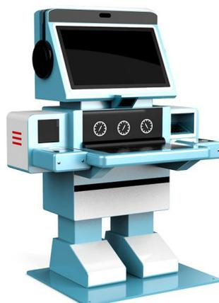
**产品简介：**XC-BM107-P 型少儿自助借还书机，结合了无线射频识别、计算机、网络、触摸屏控制操作以及软件等技术，设备包括机壳组件、工业控制计算机、触摸显示屏、标签读取装置、借书卡读取装置、身份证读取模块、打印机装置等，可实现对安装有电子标签的图书进行自助借阅、自助归还、续借及借阅查询等功能，提高图书管理及流通效率。
