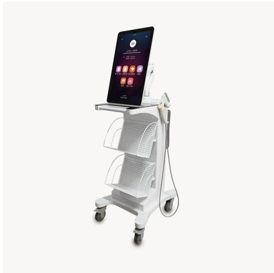
**产品简介：**XC-BM302 型智能图书自助盘点计算机是以图书标签为流通管理介质，以单面单联书架的一层作为基本的图书管理设备，通过架标与层标，构筑基于数字化的智能图书馆环境，从而实现图书馆新书上架、架位变更、层位变更、图书剔旧和文献清点等工作，实现图书馆典藏的图形化、精确化、实时化和高效率。XC-BM302 配备 21.5 寸电容触摸屏，具有操作界面友好，数据处理能力强，RFID 标签读取性能出色等特点，内置锂电池续航时间长，可实现实时电量状态监测，通过指示灯显示电池状态（充电、电源、放电），电量低和充满电时报警提醒。
