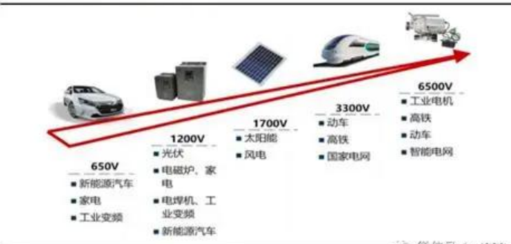
图 7: 不同电压级别 IGBT 的应用场景
